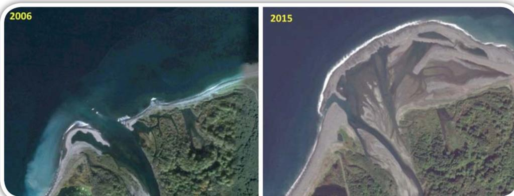
Figura 8 – Confronto tra la foce del fiume Elwha prima (2006) e dopo la demolizione delle due dighe che lo sbarravano (2015). È evidente la ricostituzione della spiaggia che prima, a causa della presenza delle dighe, era in arretramento.
